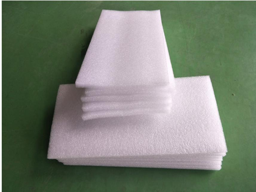
珍珠棉具有无数汽泡，体轻，防震、防摔，富有弹性，具有隔音降噪，防震防、防刮擦的作用，能够预防在传送过程中对物品的挤压、振动及磨擦等，对怕挤怕压电子产品具备一定的保护功效，在保护电子产品同时，也不容易给电子产品的运送增加重量负担。此外，根据在原材料中添加不一样的添加剂还可以制造防静电等各种各样型气泡袋，防静电气垫袋，用以包装电子元器件、部件，如集成电路芯片、卡等，既能预防静电又能具有缓冲防震的功效。
